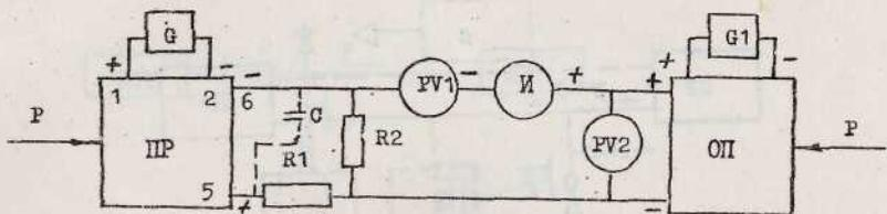
б) Включение сопротивления нагрузки ( $R_1 + R_2$ ) последовательно с источником питания
