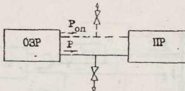
ОЗР - образцовый задатчик давления и (или) разрежения (например, "Воздух-250");
