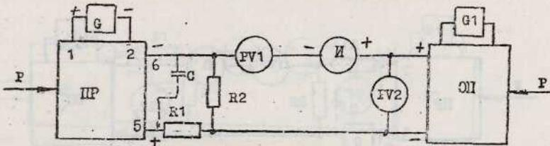
ОП - образцовый преобразователь давления и (или) разрежения с выходным сигналом в виде напряжения постоянного тока (например, преобразователь ИЩ). В качестве ОП может быть использован образцовый преобразователь с токовым выходным сигналом с пошлифованным к нему образцовым опорным сопротивлением;
