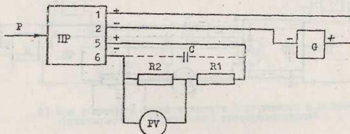
б) Включение сопротивления нагрузки последовательно с источником питания
