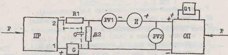
И - образцовый источник опорного напряжения (например, потенциометр Р-363-І).
