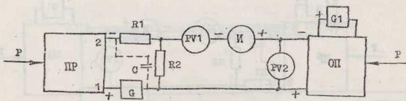
И - источник опорного напряжения (например, потенциометр Р-363-1)
