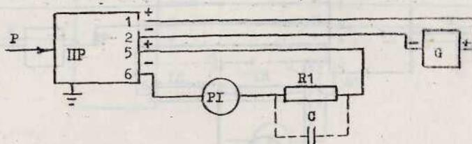
б) Включение образцового сопротивления нагрузки
